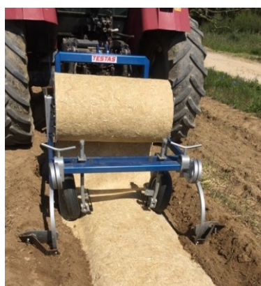
Pose mécanisable avec une dérouleuse
